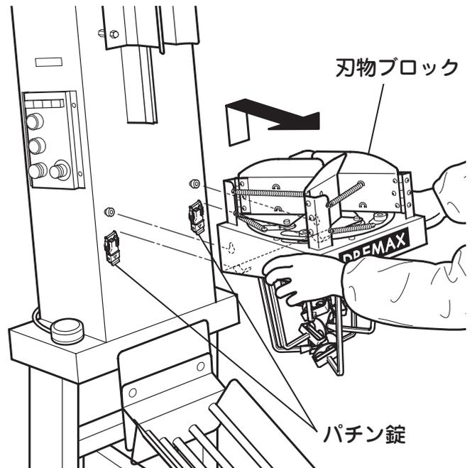
**1** 刃物ブロックを固定しているパチン錠を解除し、矢印の方にはずします。
