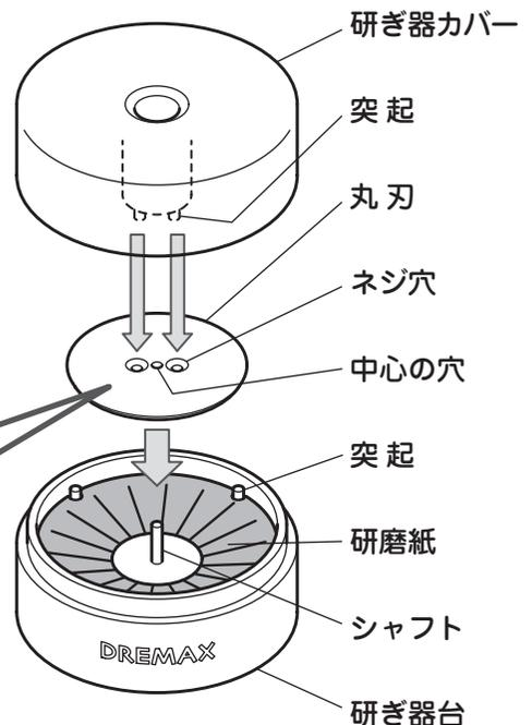
③ 研ぎ器カバーの2箇所の突起が丸刃のネジ穴にはまるようにかぶせてください。
