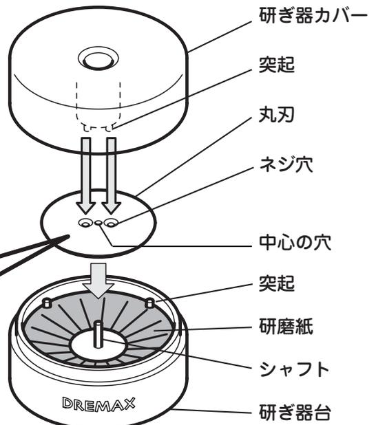
③ 研ぎ器カバーの2箇所の突起が丸刃のネジ穴にはまるようにかがせてください。
