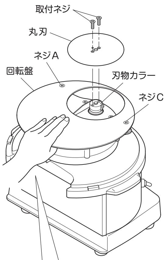
丸刃の取付ネジを取り外し・取り付けをする時に回転盤を押さえた手を滑らせてしまうと大変危険です。
