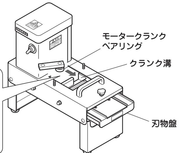
**6** 一旦 ON/OFF スイッチを「ON」にして、刃物盤が前後にスライドするかテストしてください。
