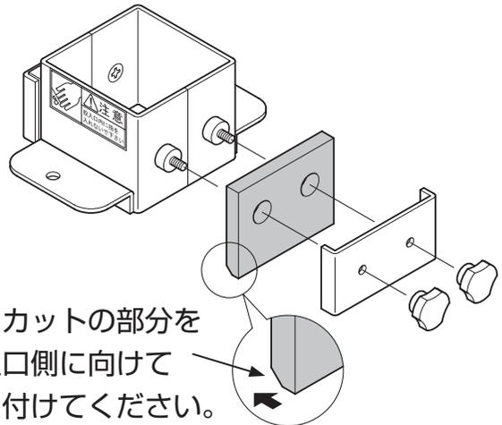
斜めカットの部分を投入口側に向けて取り付けてください。
