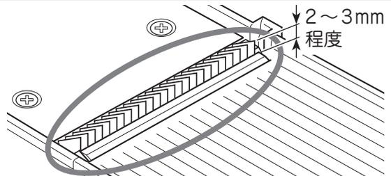
クシ刃が平刃よりも上がりすぎている状態です。(2~3mm 程上がってしまっています。) 差し口にクシ刃を挿入する際、少々力を入れて押し込む必要があります。下まで押し込みをせずに途中で止めてしまいますと、上の図のようになります。ご注意ください。
